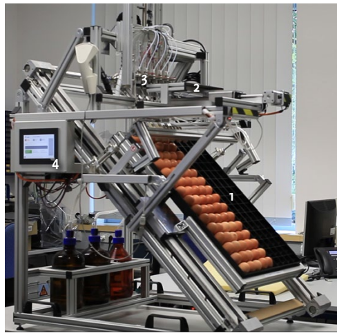
Bild 3: In-ovo-Tester des IMMS als Prototyp 1.0. u.a. mit (1) Aufnahme für eine Horde (15 Zeilen, 5 Spalten für 75 Eier), (2) Aufnahme und Aktorik für Titerplatten, (3) Stechmodul, (4) Anzeige- und Bedieneinheit. Foto: IMMS.
